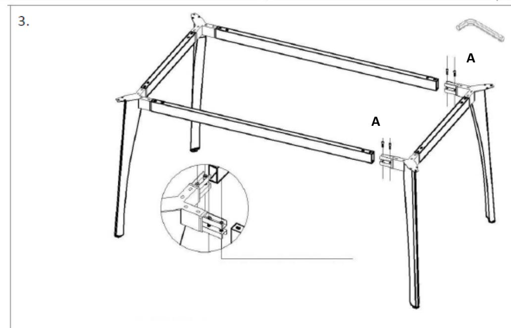
**CZ:** Krok 1-3 - Šrouby není potřeba z rozpěry (**A**) vyjímat. Zasuňte rozpěru (**A**) do konstrukce a poté utáhněte šrouby inbusovým klíčem tak, aby se hlava šroubu schovala co nejvíce pro jednoduché zasunutí rozpěry (**viz obrázky**).
