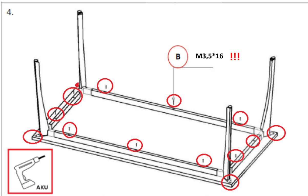
**CZ:** Na desce nejsou předvrtané díry! Pro montáž použijte vruty **M3,5\*16** z montážního balíčku **607221**. Všechny šrouby dotahujte ručně!
