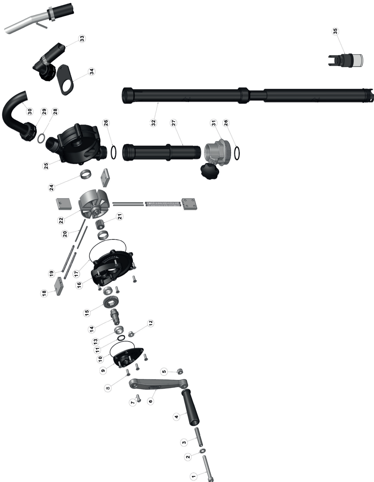
Ilustr. 9.-1: Rysunek eksplozyjny pompy na korbę
