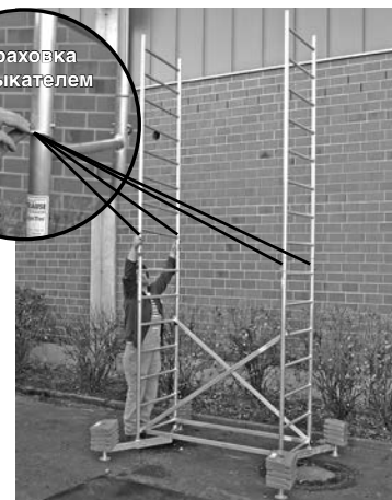
Базовая конструкция с первой и второй надстройками
