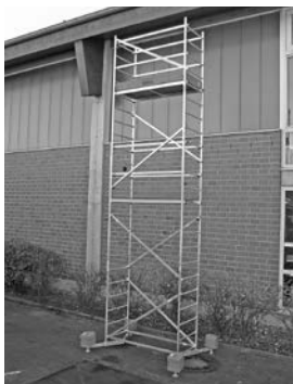
Grundmodul med første og anden tilbygning
