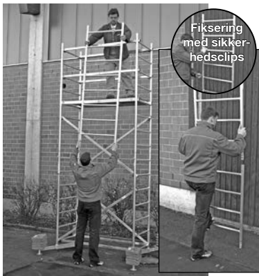
Grundmodul med første og anden tilbygning
